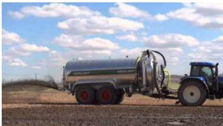
Las cisternas localizadoras son las que disponen en la parte posterior de la cisterna de un dispositivo de distribución para llevar el producto hasta colocarlo en el suelo, en base a diferentes sistemas de apertura e incluso, en su caso, de cierre del hendido, una vez localizado el purín. La uniformidad en la distribución es elevada, se reducen olores y las pérdidas de amoníaco.
